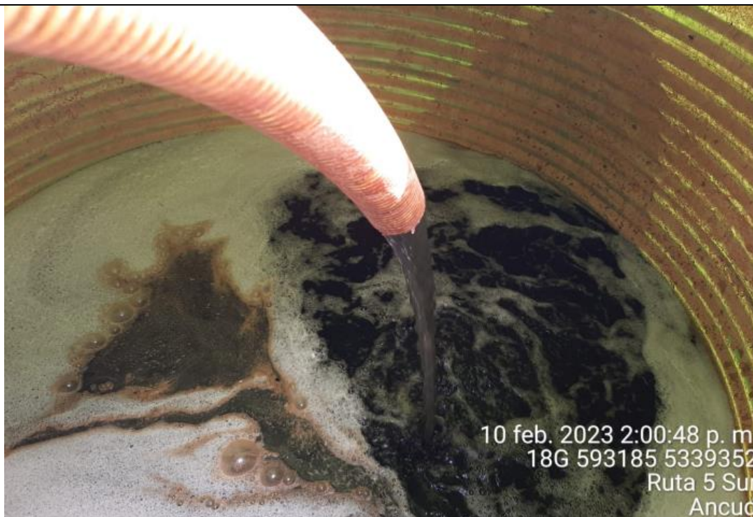
Fotografía N°20: Extracción de Lixiviados a estanque. Tomada: Viernes 10 de Febrero del 2023.
