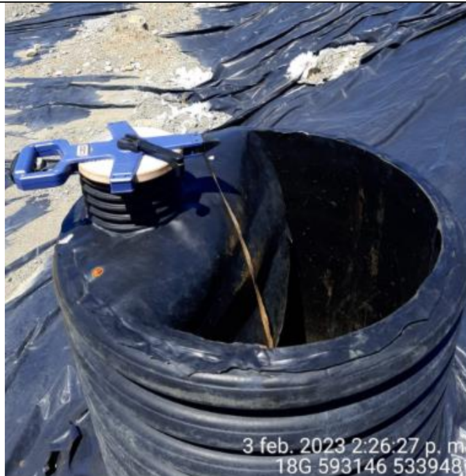
Fotografía N°28: Medición de Niveles de cámaras por Personal Municipal. Tomada: 03 de Febrero del 2023.
