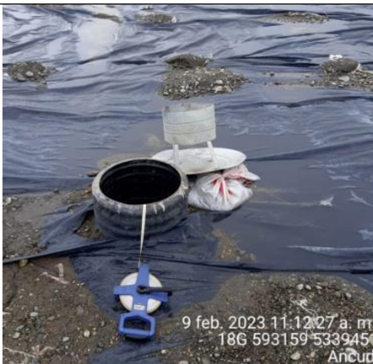
Fotografía N°32: Medición de Niveles de cámaras por Personal Municipal. Tomada: 09 de Febrero del 2023.
