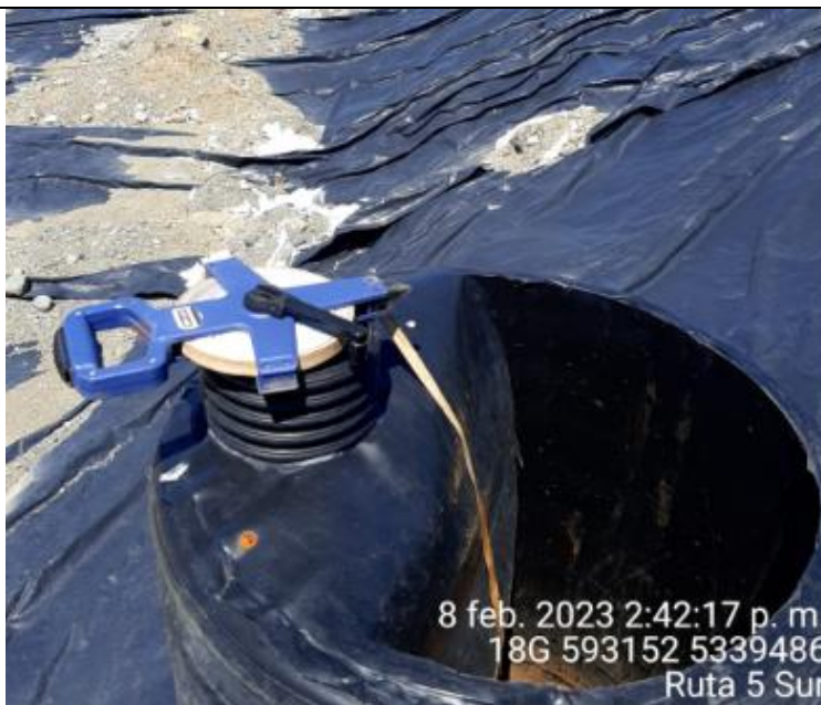
Fotografía N°31: Medición de Niveles de cámaras por Personal Municipal. Tomada: 08 de Febrero del 2023.
